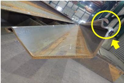
本施設は土留鋼矢板が躯体外型枠となることから、止水性が求められる。漏水防止のため隅角部は特殊セクションのコーナー矢板を製作し施工した。
