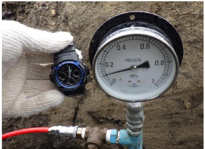
日々施工毎の気密試験による施工管理
