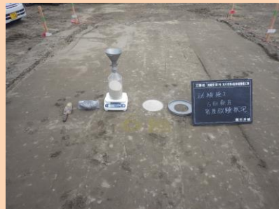
路床盛土の施工において試験施工を実施し、路床締固め度の規格値を満たす転圧回数で転圧を行った。また、雨水が溜まらないように排水勾配を考慮して施工を行い、品質向上に努めた。
