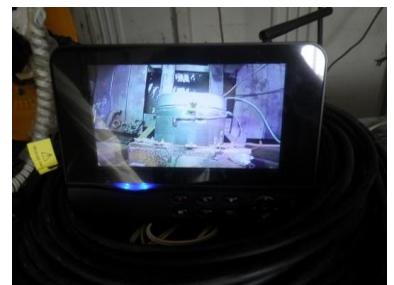
推進オペレーターからは立坑内の作業状況が把握しにくいことから、監視カメラを設置することで、安全管理に努めた。
