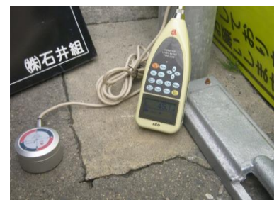
開削区間において、県道の路盤が安定処理されており、通常のバックホウ掘削では困難を極めた。 振動や騒音を測定しながら、近隣へ影響を与えない最適工法を選定し施工した。
