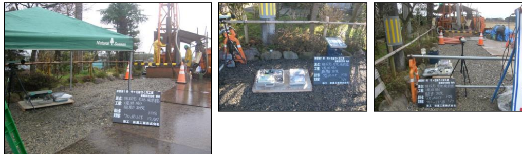
さく井掘削作業中の振動・騒音の測定を行い、基準範囲内での作業管理を行った。
