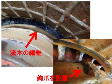
流木による面板閉塞対策として、生木繊維を掻き出す構造へ改造。
