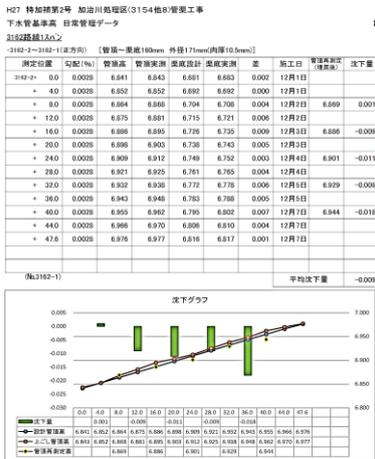
管渠の沈下量分析データ
