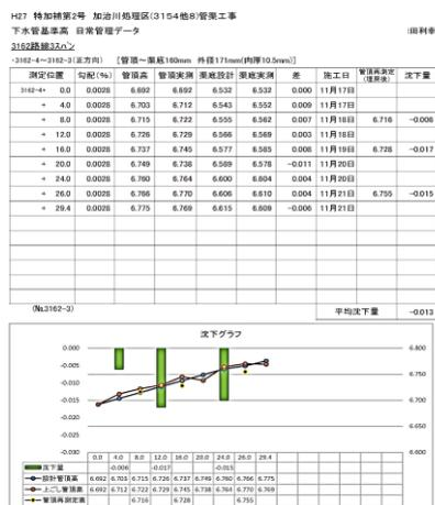
管渠の沈下量分析データ
