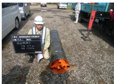
流木による推進阻害が懸念されることから、泥土圧式推進から泥水式推進へ工法変更 また、推進路線によっては、砂礫層での土砂過剰取込みを防止するため、開口率の少ない面板を採用
