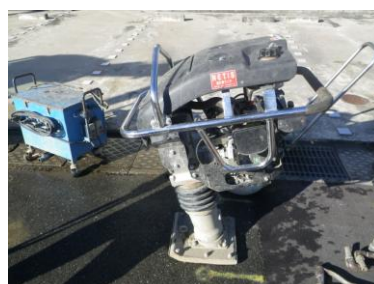
高打撃ランマ使用による締固め作業の効率化
