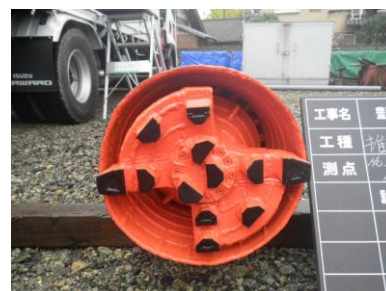
流木による推進阻害が懸念されることから、泥土圧式推進から泥水式推進へ工法変更 また、推進路線によっては、砂礫層での土砂過剰取込みを防止するため、開口率の少ない面板を採用
