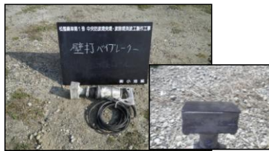
バイブレータだけでなく、スペーシング器も併用して気泡の軽減対策を実施
