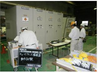
高圧受変電設備 工場製品検査の実施
