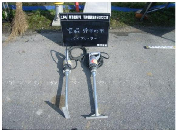
管脇埋戻し時にT字型バイブレーターの使用
