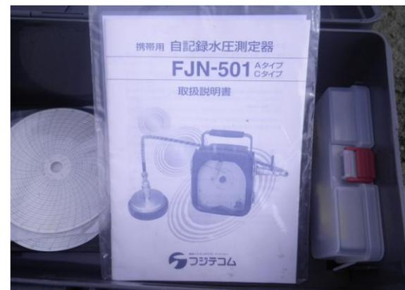
圧送管の水圧試験時に、自記録水圧測定器を使用
