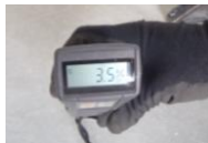
水分計を活用し、材料及び下地の含水率を測定し、施工後の狂い、剥がれ等の防止に努めた。
