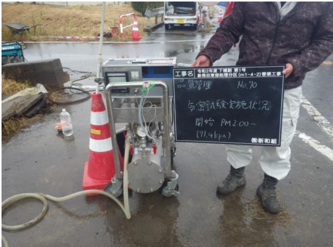
圧送管布設完了区間の定期的な気密試験による施工管理
