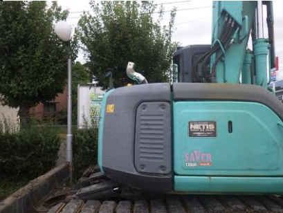
使用重機の排気口加工状況
