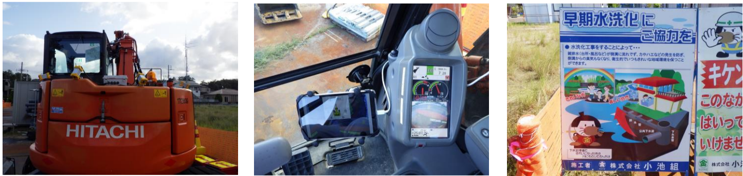
・360° 視野のバックホウカメラシステムを搭載し、安全な施工に大きく寄与している。
