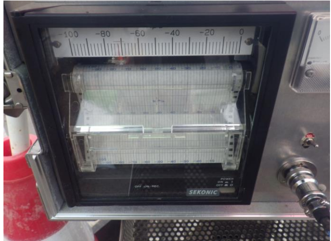
圧送管布設完了区間の定期的な気密試験による施工管理
