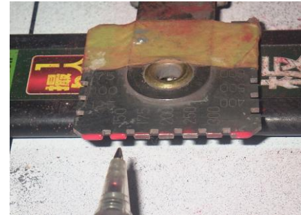
【塗装工】ウエットゲージを用いて塗装塗膜厚を確認しながら施工
