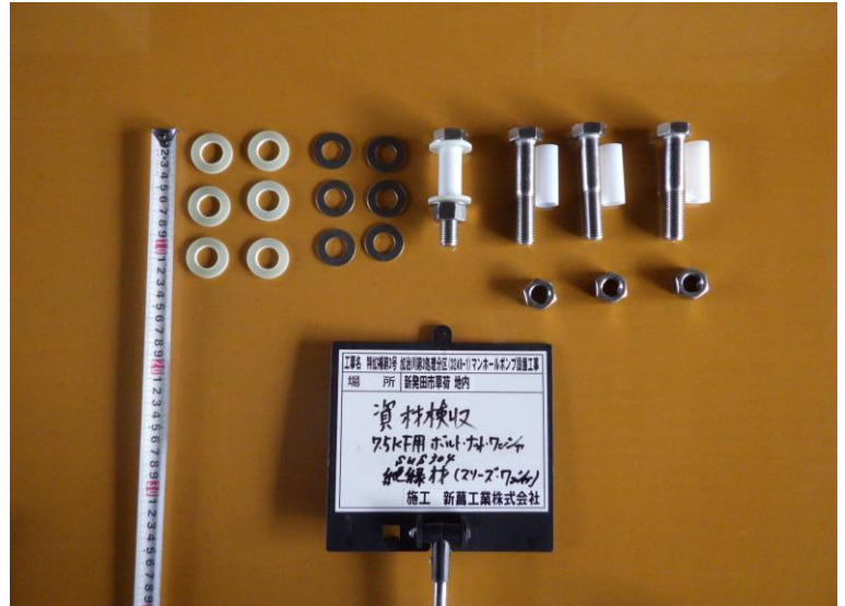
・材質以外にもポリエチレンスリーブで覆うことによる腐食防止及び、接合材料の工夫による電食防止。
