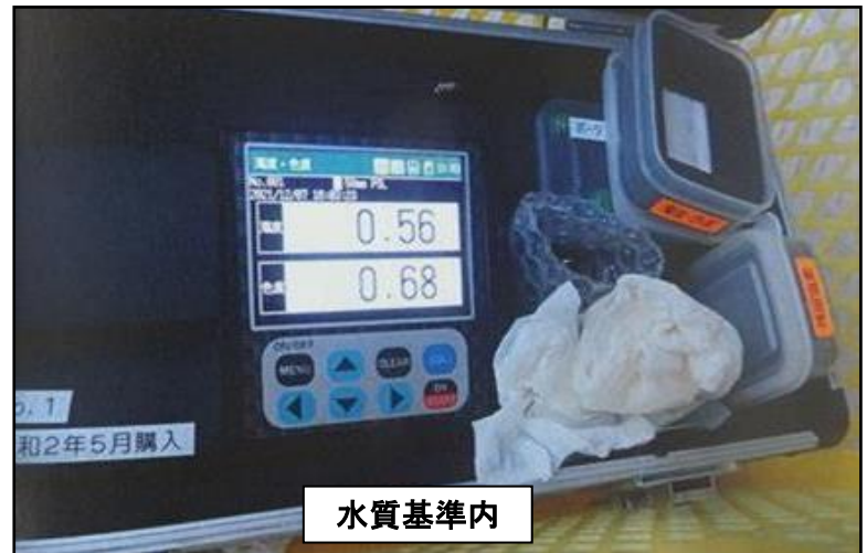
排泥管を設置し、配水(水道水)の濁りが無くなるまで排泥作業を実施
