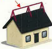
命綱固定アンカー
